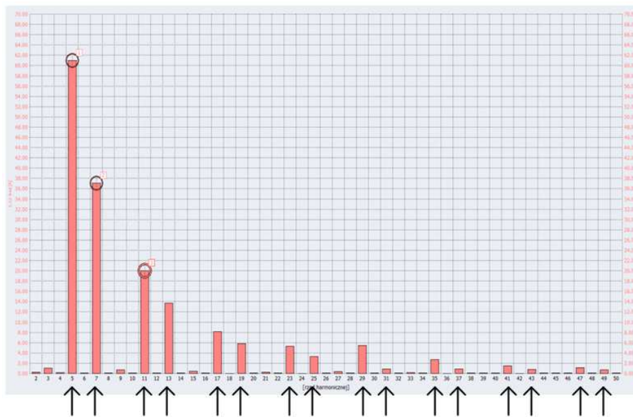
Rys. 6. Wartości wyższych harmonicznych (pomiar 1). ↑ - oznaczenie harmonicznych charakterystycznych
