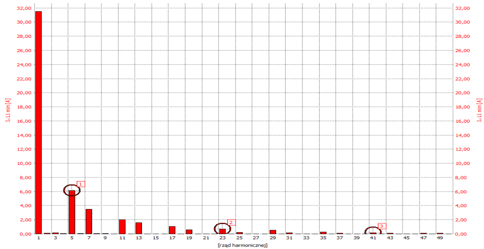
Rys. 10. Zarejestrowane przebiegi I_H L-1 (pomiar 2) w podstacji trakcyjnej. Fig 10. Recorded I_H L-1 waveforms (measurement 2) in the traction substation.
