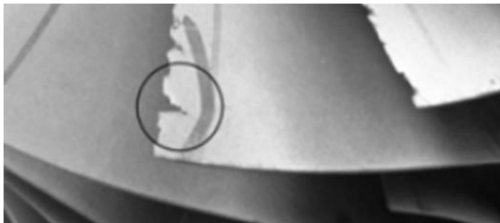
Rys. 6. Rozerwania łopatek wirnika sprężarki (fot. B. Przybyła)
