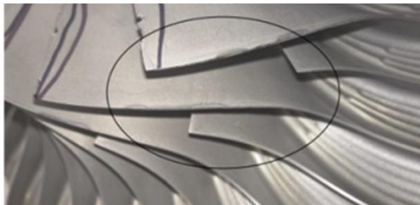
Rys. 9. Uszkodzenia erozyjne krawędzi łopatek wirnika sprężarki (fot. B. Przybyła)
