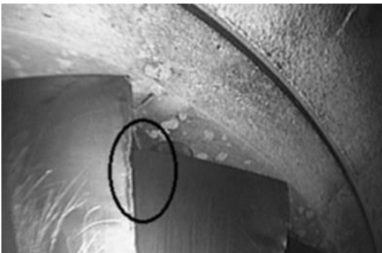
Rys. 5. Wgniecenia krawędzi natarcia wirnika sprężarki (fot. J. Haliniak)
