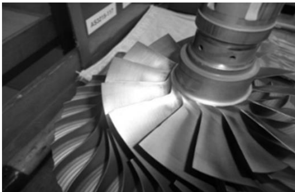
Rys. 18. Wirnik sprężarki po remoncie (fot. P. Rutkowski).
