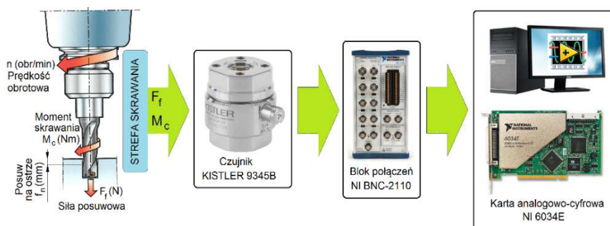
Rys. 3. Tor pomiarowy wraz z systemem akwizycji danych
