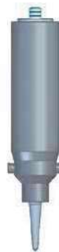
Fig. 4. A 3D model of the adhesive spreader's head Rys. 4. Model 3D głowicy nakładarki do kleju
