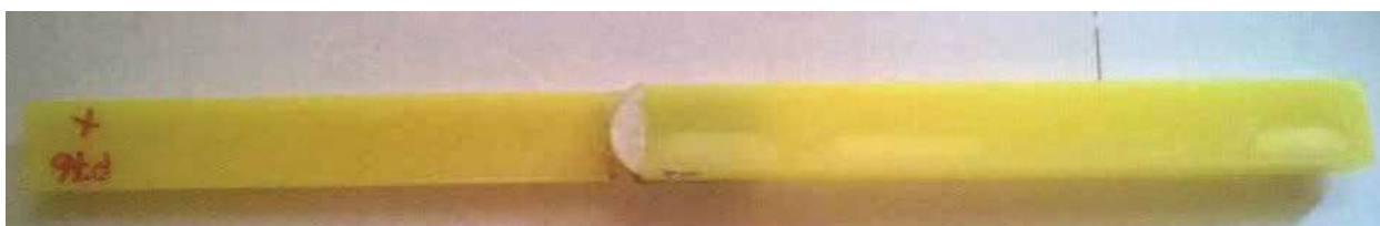
Fig. 4. The example of adhesive joint made of polyacetal HIPS 425N, using composition of adhesive Epidian 6/TFF/100:27 Rys. 4. Przykładowe połączenie klejowe wykonane z poliacetalu HIPS 425N przy zastosowaniu kompozycji klejowej Epidian 6/TFF/100:27
