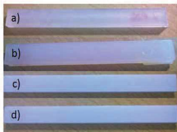
Rys. 2. Próbki wykonane z tworzyw: a) polipropylenu, b) poliamidu, c) poliacetalu, d) polistyrenu
