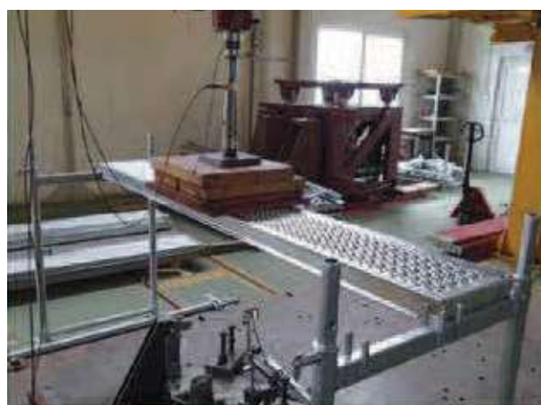
Rys.4. Ocynkowany podest z blachy stalowej HC260LA na stanowisku badawczym
