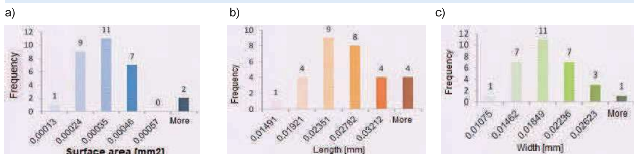
Fig. 9. Measurements of abrasive micrograins 95A F 500: a) distribution of area A, b) distribution of length l, c) distribution of width s Rys. 9. Pomiary mikroziaren 95A F500: a) rozkład pola powierzchni A, b) rozkład długości l, c) rozkład szerokości s
