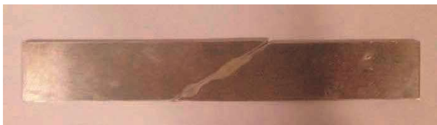
Rys. 4. Przykładowe połączenie klejowe wykorzystywane w badaniach o kącie zukosowania próbki wynoszącym 30° Fig. 4. Examples of the bonded joint used in the study with bevel angle of 30° of the sample
