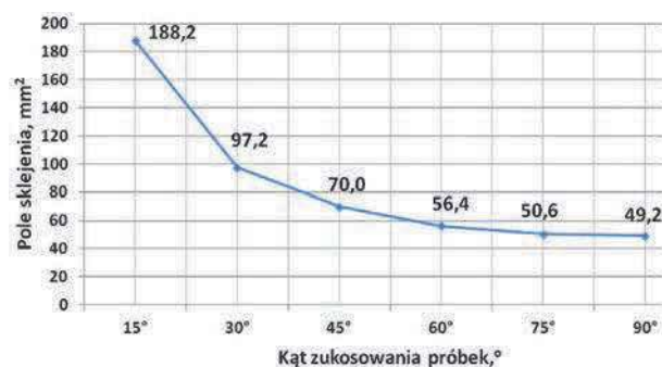
Rys. 6. Wpływ kąta zukosowania próbek na pole sklejenia Fig. 6. The influence of bevel angle of samples on bonding field
