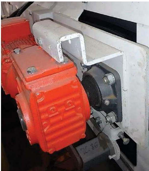
Rys. 1. Mocowanie motoreduktora za pomocą uchwyty giętego [4] Fig. 1. Fixing the gear motor with the handle bent [4]
