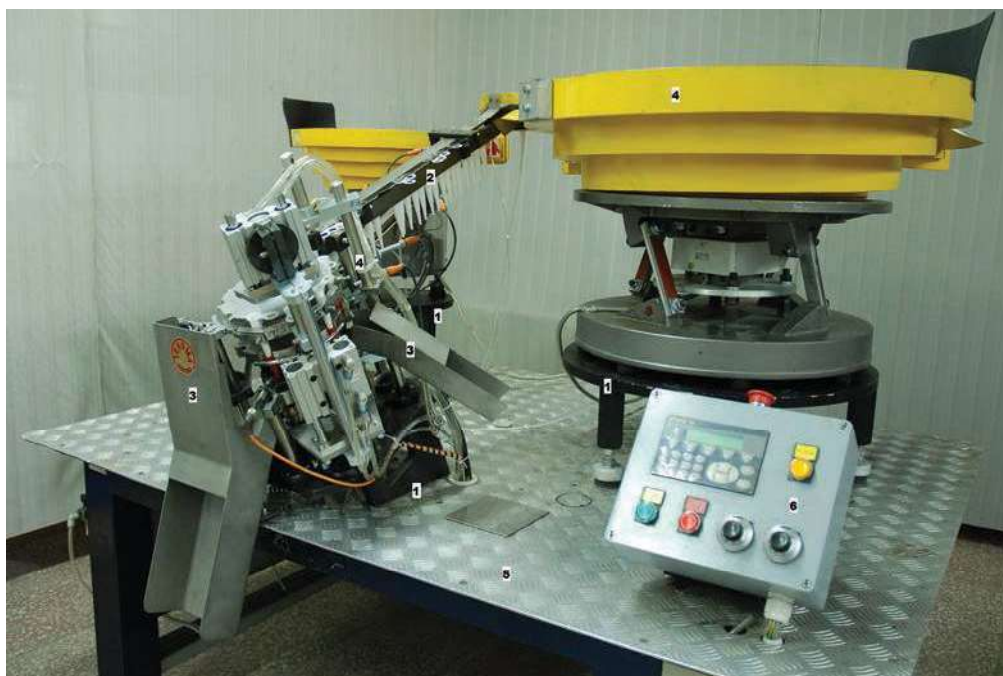
Rys. 1. Urządzenie do montażu aplikatorów. Na rysunku zaznaczono elementy, w których możliwe jest wykorzystanie materiałów kompozytowych: 1 – podstawy, 2 – rynny zsykowe podające, 3 – rynny zsykowe odprowadzające, 4 – zasobniki podajników, 5 – blat stołu maszyny, 6 – obudowa pulpitu sterowania
