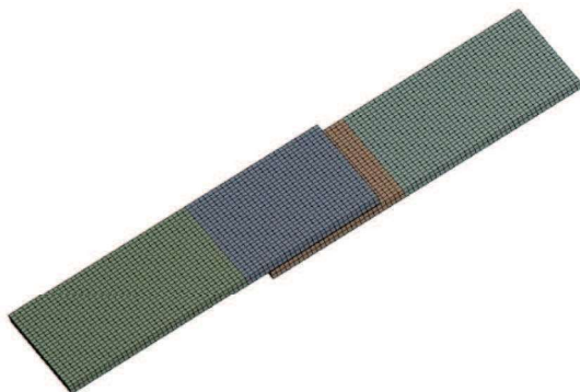
Rys. 3. Model połączenia zakładkowego Fig. 3. Numerical model of lap joint
