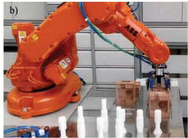
Rys. 2. Montaż reduktora: a) przykładowa zaprojektowana ścieżka narzędzia (chwytaka) operacji montażu reduktora, b) zdjęcie z realizacji zaprojektowanej ścieżki na stanowisku laboratoryjnym [7]
