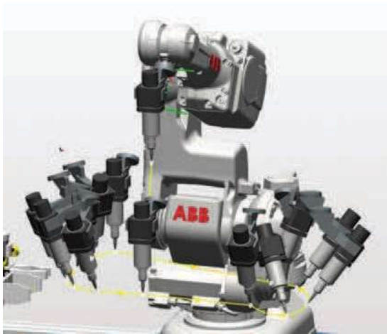
Rys. 4. Ścieżka narzędzia do nakładania masy uszczelniającej [7]
