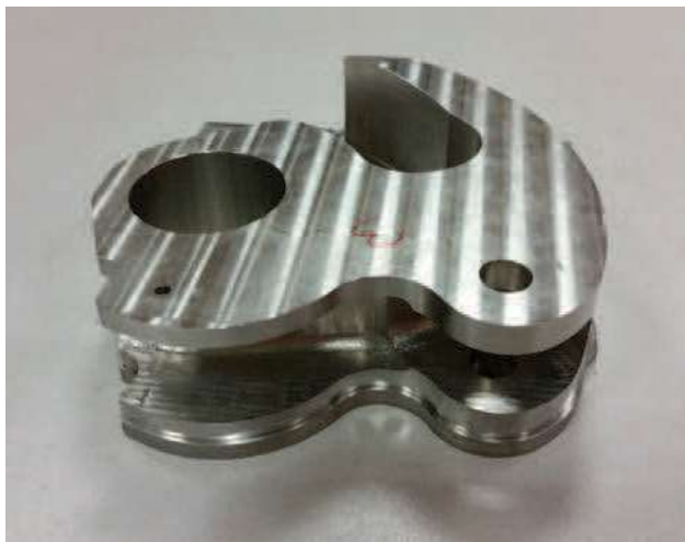
Rys. 2. Element typu dźwignia po obróbce frezowaniem Fig. 2. The lever element after milling
