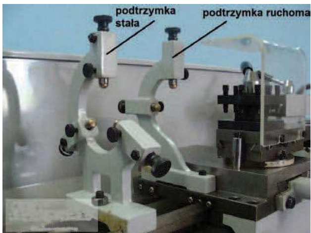
Rys. 9. Podrzymki stała i ruchoma Fig. 9. Steady rests: stationary and movable
