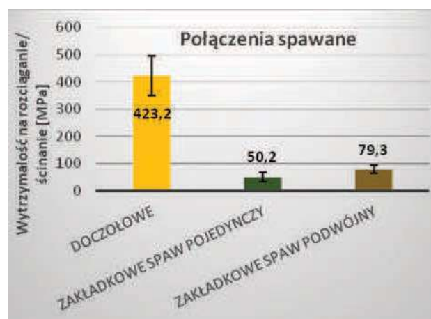
Rys. 6. Wytrzymałość połączeń spawanych blach ze stali S235JR Fig. 6. The results of the strength of welded joints S235JR steel sheets
