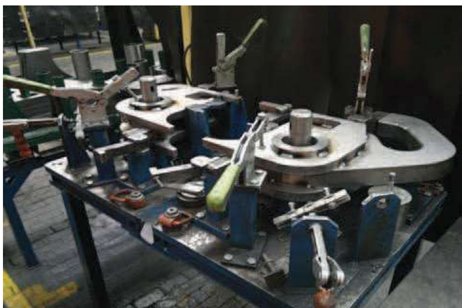
Rys. 1. Przyrząd do operacji unieruchamiania części składowych zawiasów podczas ręcznego spawania (zbiory własne autora) Fig. 1. Assembly jig for hinge components during manual welding
