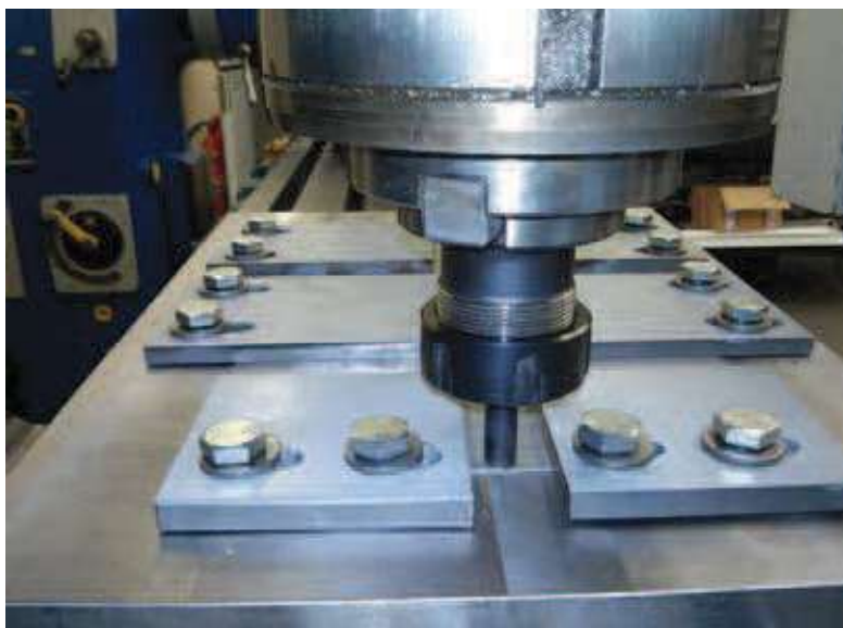
Rys. 2. Głowica narzędziowa i próbki do zgrzewania tarcowego Fig. 2. View of head with tool and FSW specimen
