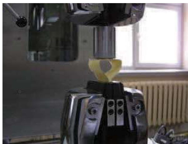
Rys. 3. Próbkę zamocowaną w uchwytach maszyny wytrzymałościowej Fig. 3. The sample mounted in the grips of the testing machine
