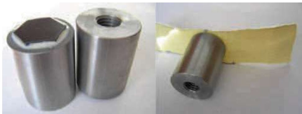
Rys. 2. Próbkę z wklejoną ceramiką i przyklejonym paskiem tkaniny Fig. 2. Ceramics adhesively bound to socket of specimen and strips of fabric adhesively bound to ceramics
