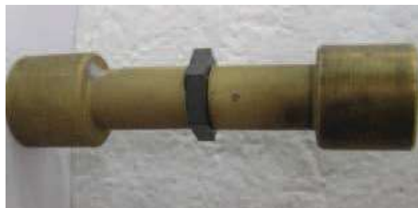
Rys. 6. Próbką stosowaną w badaniach właściwości adhezyjnych ceramik w próbie odrywania
