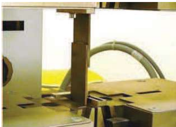
Rys. 3. Zamocowane połączenie klejowe w maszynie wytrzymałościowej
