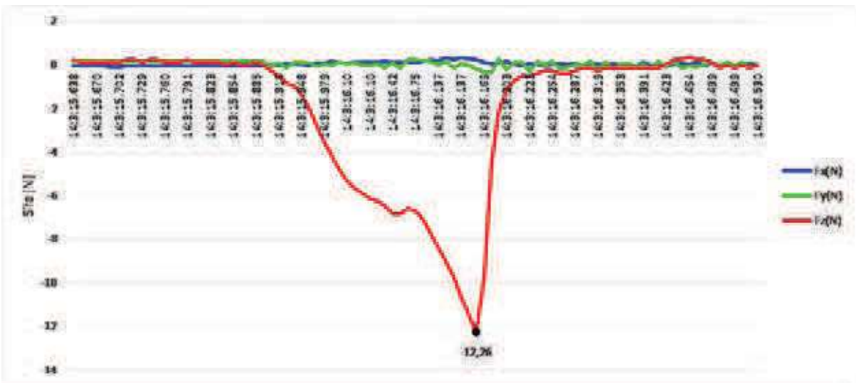
Rys. 10. Wykres zmiany sił dla prędkości 100 mm/s [6] Fig. 10. Graph of change of forces for speed 100 mm/s [6]
