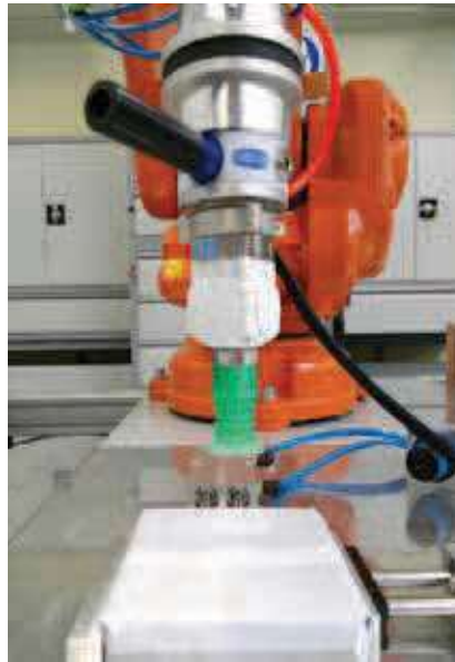
Rys. 5 . Sposób zamocowania opakowania proszku do prania [6] Fig. 5. The way the laundry powder package is attached [6]
