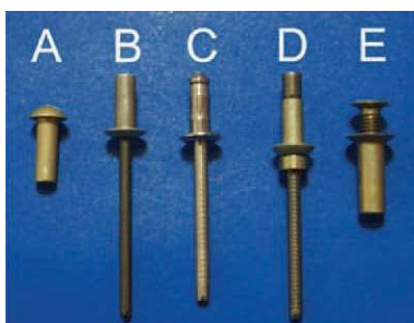
Rys. 2. Widok nitów wykorzystywanych w badaniach: A) nit pełny, B) nit zrywalny szczelny, C) nit zrywalny ze stali nierdzewnej typu Zenair, D) nit zrywalny typu Cherry MBC® NAS1720, E) nit typu Goodrich
