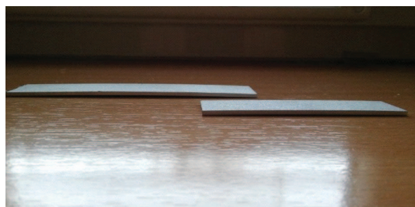
Rys. 1. Odkształcenia próbek metalowych spowodowane jednostronnym piaskowaniem powierzchni
