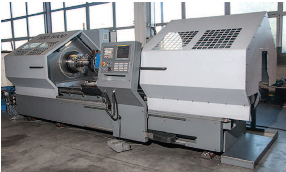
Rys. 1. Tokarka TUG1200/1400 – widok ogólny Fig. 1. CNC Lathe TUG1200/1400 – overall view
