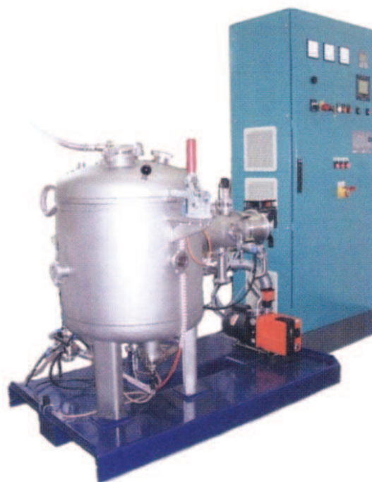
Rys. 4. Urządzenie HLA do wytwarzania narzędzi diamentowych metodą lutowania w próżni produkcji firmy Trenker Diamant-Anlagen-Technik [16]
