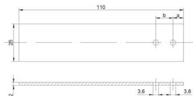
Rys. 1. Rozmieszczenie otworów pod nity a = 2d = 7 mm, b = 3d = 10,5 mm
