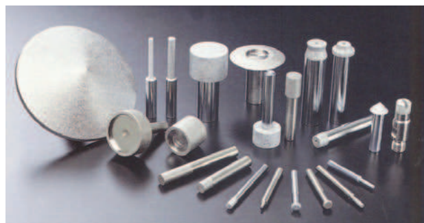
Rys. 5. Narzędzia diamentowe wytworzone metodą lutowania w próżni [14]
