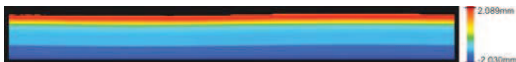
Rys. 7. Przykładowy wynik skanowania w postaci rozwinięcia powierzchni dolnej uszczelniacza (bez wady) Fig. 7. An example of the scanning result in the form of developed of the bottom seal surface (without defects)
