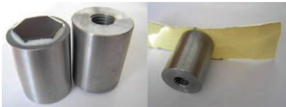
Rys. 2. Próbkę z wklejoną ceramiką i przyklejonym paskiem tkaniny Fig. 2. Ceramics adhesively bound to socket of specimen and strips of fabric adhesively bound to ceramics
