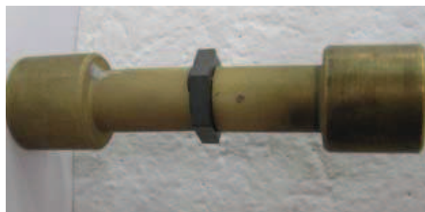
Rys. 6. Próbką stosowaną w badaniach właściwości adhezyjnych ceramik w próbie odrywania Fig. 6. Specimen used in the adhesive properties testing of the ceramics subjected to stretching
