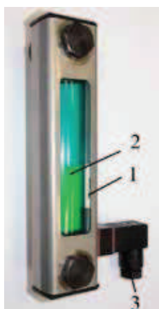
Rys. 1. Płynowskaz z sygnalizacją poziomu cieczy: 1 – pływak z magnesem, 2 – kontaktron, 3 – złącze elektryczne Fig. 1. Liquid level indicator with liquid level signalling: 1 – float with magnet, 2 – reed switch, 3 – electrical connector
