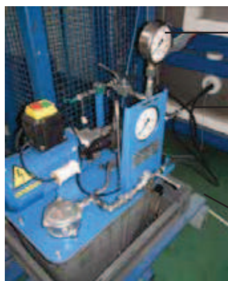
Rys. 6. Widok stanowiska badawczego: a) hydrauliczny układu kontrolnego do sprawdzania szczelności płynowskazów na zewnątrz komory klimatyzacyjnej, b) płynowskaz zainstalowany we wnętrzu komory klimatyzacyjnej podczas badań Fig. 6. View of the test stand: a) hydraulic control system for checking the tightness of liquid level gauges outside the air-conditioning chamber, b) liquid level indicator installed inside the air-conditioning chamber during testing
