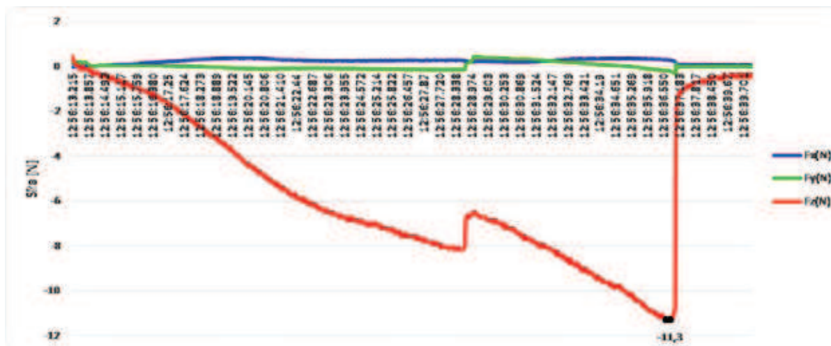
Rys. 8 . Wykres zmiany sił dla prędkości 1 mm/s [6] Fig. 8. Graph of change of forces for speed 1 mm/s [6]
