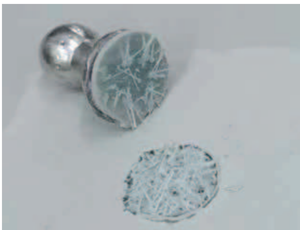
Fig. 3. Adhesive destruction of gelcoat layer – experiment E12 Rys. 3. Zniszczenie adhezyjne warstwy żelkotu – eksperyment E12
