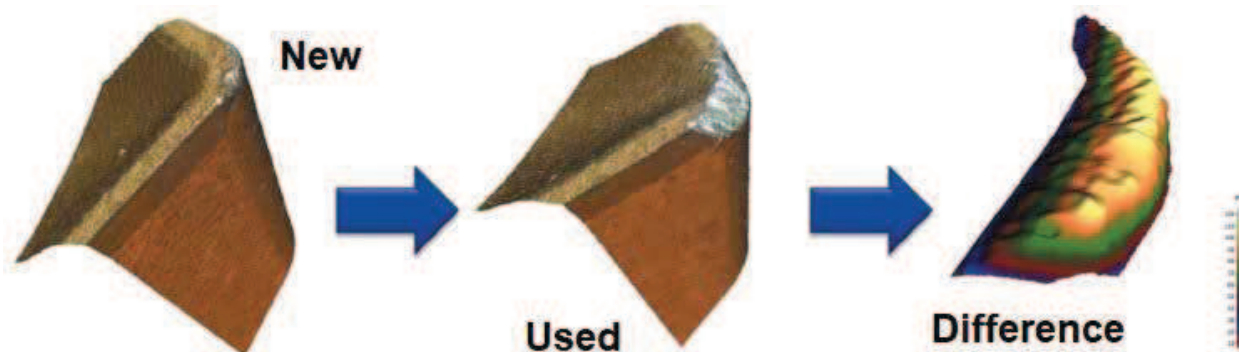
Fig. 4. Comparison of a fragment of a new tool and a worn tool [1] Rys. 4. Porównanie fragmentu narzędzia nowego i zużytego [1]
