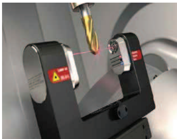
Fig. 3. System of contactless measurement of the tool, using laser beam [9]. Rys. 3. Układ bezdotykowego pomiaru narzędzia za pomocą wiązki lasera [9]
