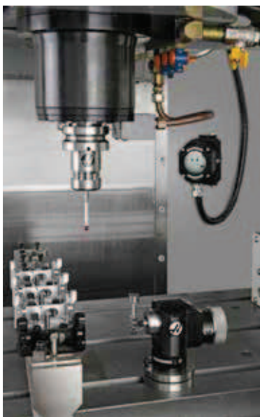
Fig. 1. System of touch measuring probes [11] Rys. 1. System dotykowych sond pomiarowych [11]
